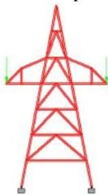
Fig. 5 Assigning dead load
