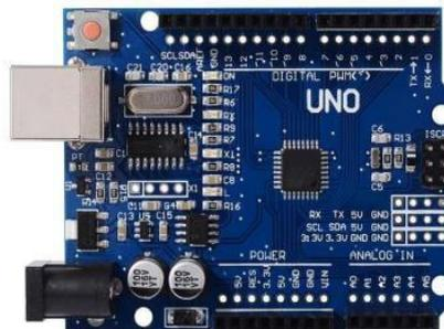
**Fig: 1 Arduino UNO Board**
