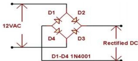
*Figure 4. Rectifier circuit.*
