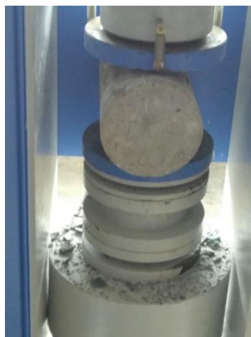
Fig. 2 Split tensile test
