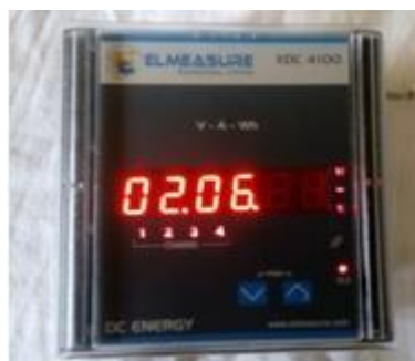
Fig.5 DC Energy Meter cum Data Logger
