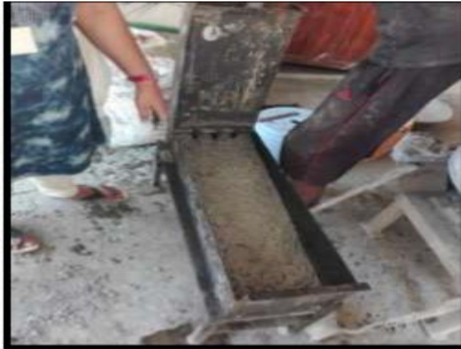
Fig.3 L- BOX TEST
