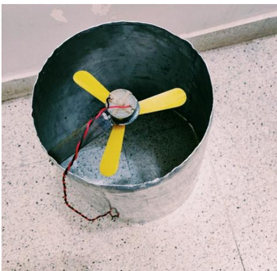
Fig 2.4: Updraft Chimney (Aluminium).
