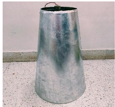
Fig 2.3: Updraft Chimney (Aluminium).
