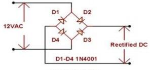
Figure 4. Rectifier circuit.
