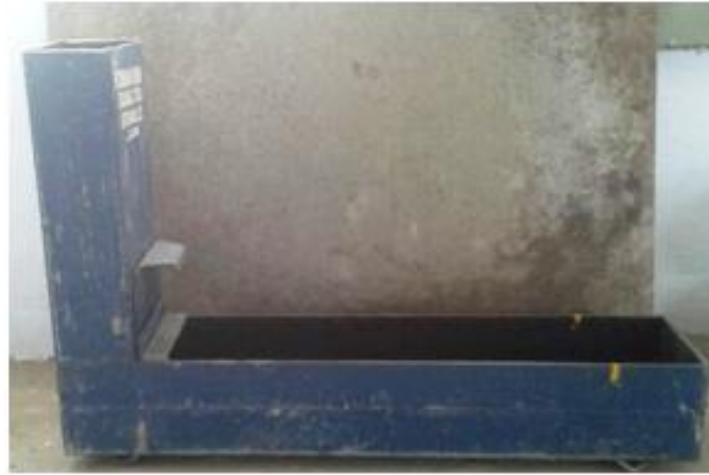
Fig. 4: L-Box test apparatus.
